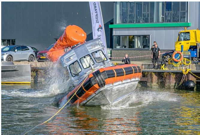
Elke nieuwe reddingboot ondergaat na de bouw een stabiliteits- en kapseisproef.
